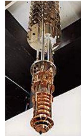
Mit der Fertigstellung und erfolgreichen Erprobung der Berliner Mikrokkelvinanlage besteht nun in der PTB die Möglichkeit, Temperaturen von nur einigen millionstel Grad über dem absoluten Nullpunkt zu erzeugen. Darüber hinaus kann in diesem Temperaturbereich das Verhalten kondensierter Materie in hohen Magnetfeldern untersucht werden.
